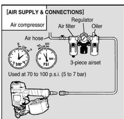
**气管接头:**本枪必须连结公座气管接头，保证连结气管时空气能自由进出，拔除气管时枪身内部不残留空气。
